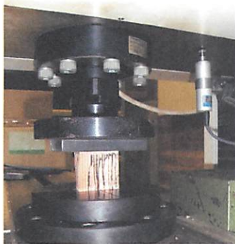
写真2 高含水率材の縦圧縮試験
