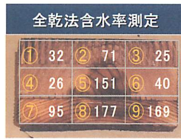
図2 高周波測定器と全乾法による含水率
