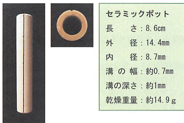
図2 セラミックポットの形状
