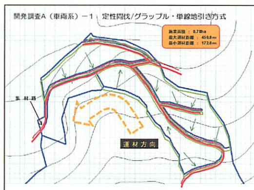
図ー1 定性間伐・車両系による作業システムと生産性結果
