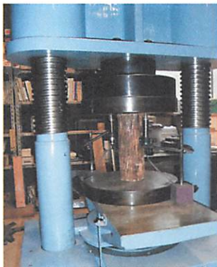
写真3 樹脂補強材の縦圧縮試験
