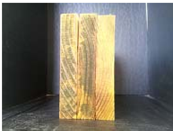
写真2 モリブデンブルーによる切断面の発色の様子 難燃剤注入長尺切片と未処理木材（右端）
