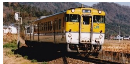
井原市〜志和口間にて 40系気動車 平成 13.12.23 20系気動車の後継車として昭和52年に登場。現在も広島〜三次間の主力車両として活躍している。
