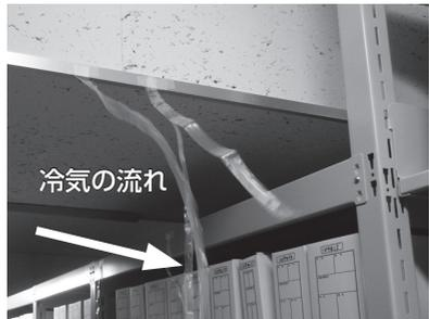
写真39 冷気の流れを確認する紐
