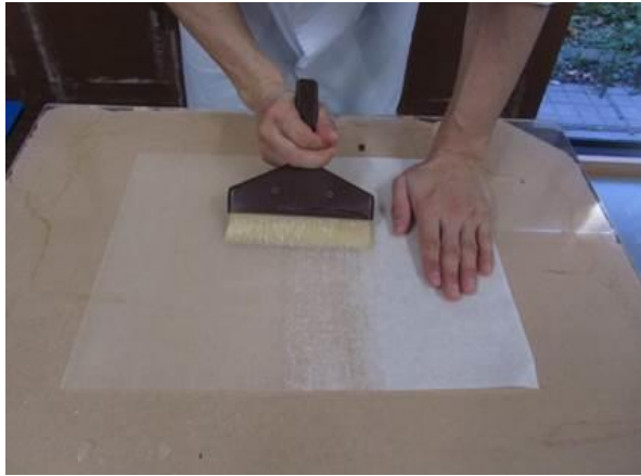
④本紙を伸ばし終えたら、本紙よりひと回り大きめに裁断した裏打ち和紙を用意し、ムラや皺をつくらないように水糊を均一につける。
