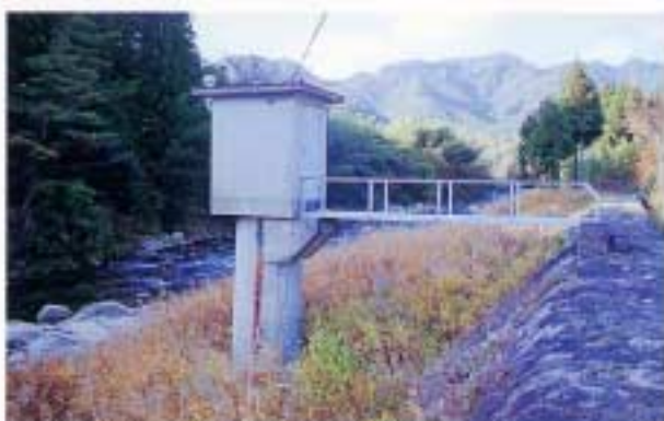
▲水位観測局 4つの観測所からテレメータでダム管理事務所へデータを集めるシステム
