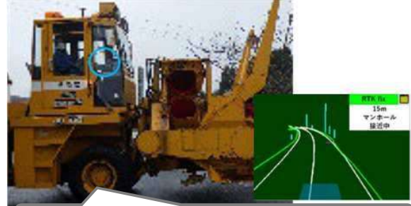
除雪車に支援システムを実装し除雪作業を支援 (R5.3)
