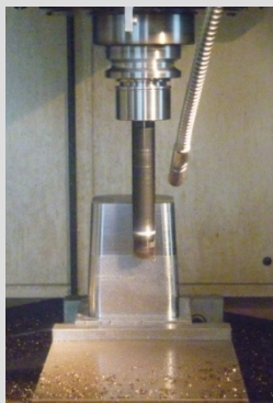
開発技術による 金型加工の様子
