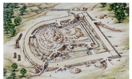
③地面を掘り下げて、周溝をつくり、その土を堀の内側に盛り上げていく。
