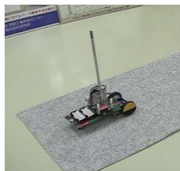
台車型倒立振り制御システム
