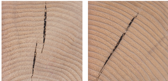
写真1 乾燥後のトドマツ心去り材 (高温セット処理あり)
