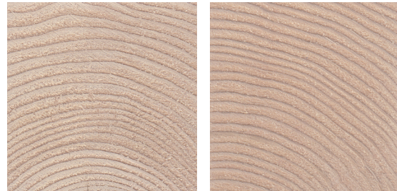
写真2 乾燥後のトドマツ心去り材 (高温セット処理なし)
