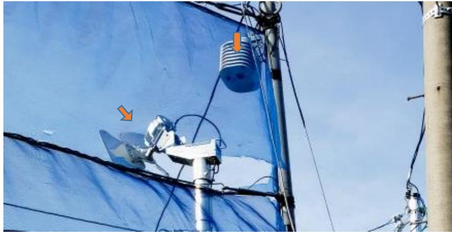
図6 逆転層（地上 6.5m 上空）のラジエーションシールド設置状況
