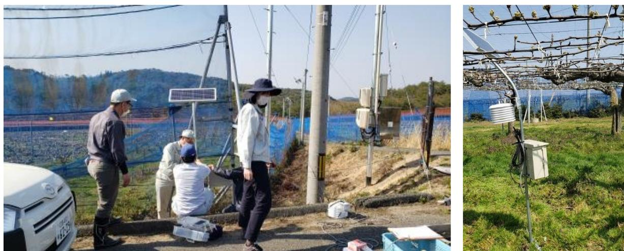
図 5 ソーラー電源の強制通風ラジエーションシールドの設置状況
