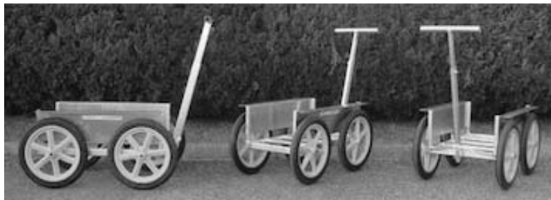
第 3-17 図 試作した 14 インチ車輪を装着した収穫台車
