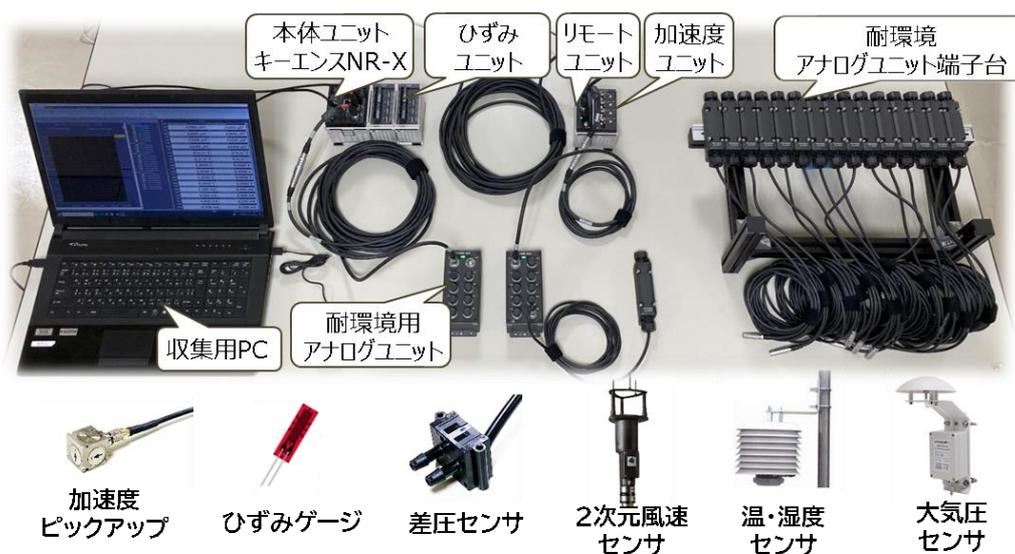
図1 計測システム
