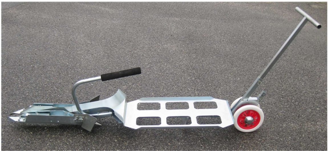
図 4-12 開発したワケギ鱗茎の植付けに対応した簡易移植機
