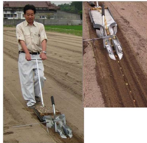
G 簡易移植機を引っ張ることで溝切り、 植付け、覆土が同時にできる
