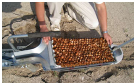
C 水稲用育苗箱を簡易移植機に装着する
