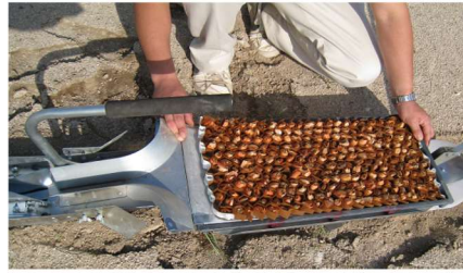
E 水稲用育苗箱を簡易移植機に装着する
