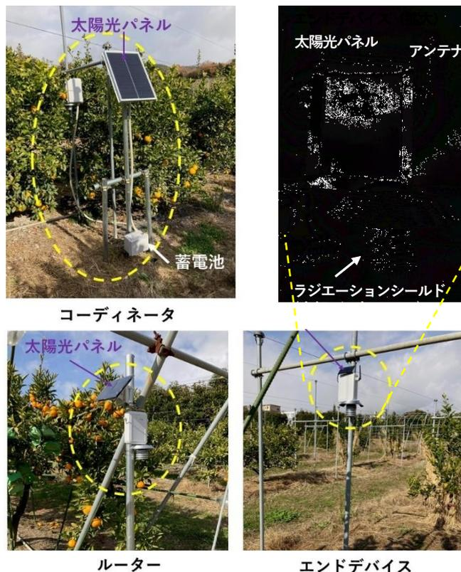
図3 圃場内に設置した IoT デバイス
