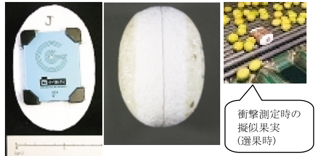
図1 加速度センサー内蔵の発泡スチロール製の擬似果実 注)縦径 129 mm, 横径 83 mm, 重量 125g (センサー込み)
