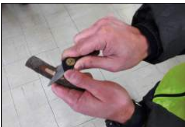
④ 刃の前には、ぜったいに指がこないように注意する。
