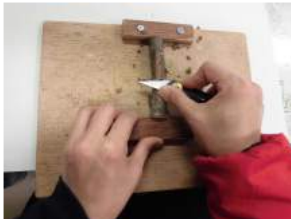
② 工作板にセットして, 切り出しナイフで削る。
