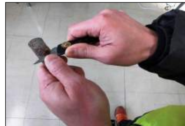
③ 刃を少したてて、左手の親指で刃を押し削る。
