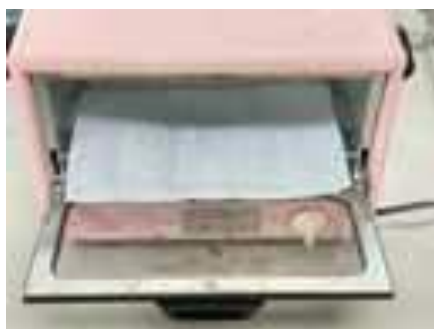
⑤ オープントースターの中にクッキングシートをしき、その上にプラスチック板をのせ、トースターのスイッチを入れると、曲がりながら約 20 秒で平面にもどり、1/4位にちぢむ。
