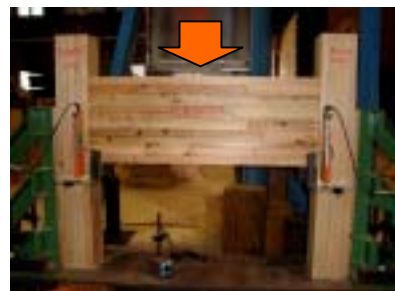
写真3 柱・梁せん断試験
