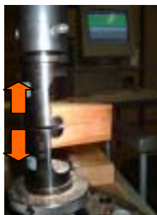
写真1 JIS 割裂抵抗試験
