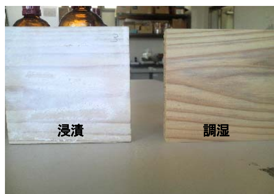
写真2 ゾルゲル処理した試験片の外観
