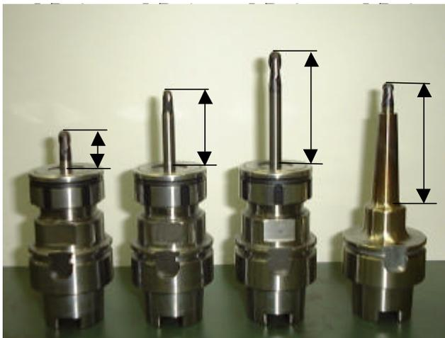
写真1 工具突出長、及び使用ホルダ
