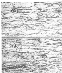
写真3 破断部の縦断面顕微鏡組織 ( \times 400 )
