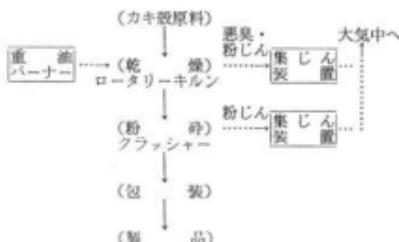
図1 カキ殻飼料製造工程と粉じんの処理
