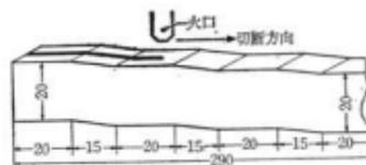
図3 火口距離決定用試験片および実験方法
