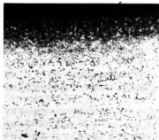
(a) 1t試験片350°Cオーステンパ、850°C×25分浸炭(×100)
