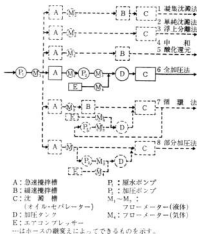
図2 テスト・プラントによる各種処理法系統図
