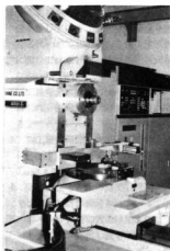
写真1 真直度測定状況
