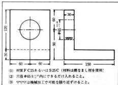
図1 内面加工用試験片図面
