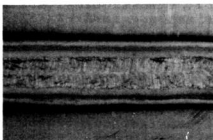
写真2 表面がひどく酸化しているビード
