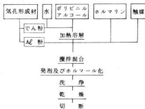
図1 PVA多孔体の製造フロー
