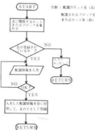
図8 階層化構造プログラムの一例(図形配置)
