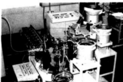
写真2 試作した組立ロボットのインデックスステーブル及びトランスファラインの上方全体写真
