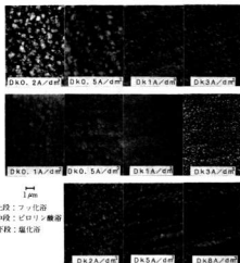
写真1 電析物の表面形態に及ぼす電流密度の影響
