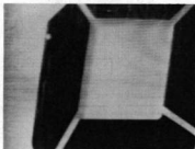
写真1 液晶表示器の欠陥例(リングファイバ照明)
