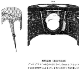
図1 ピストン1/2モデルの有限要素法による解析結果事例
