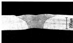
写真2 突き合わせ溶接断面 (f80, r3, E2.3, Df-2)
