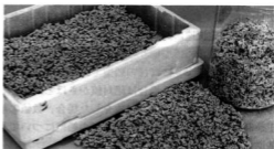
写真1 発泡PS製品の減容化チップ
