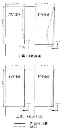
図6 切削面の輪郭形状(ワーク硬度の影響)
