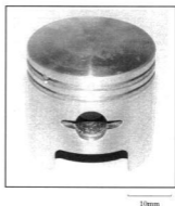
写真5 最終加工を行った芝刈り機用エンジンピストン
