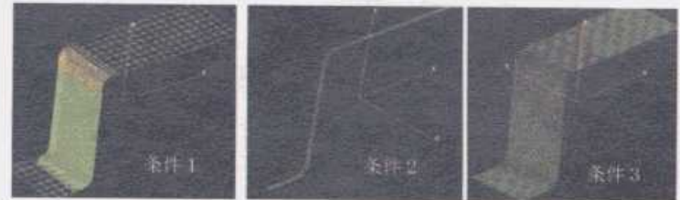
図8 曲げ成形後のU字メッシュモデル
