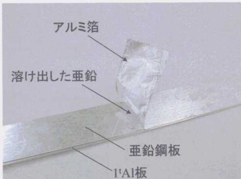
写真3 最表面にアルミ箔を接合した例
