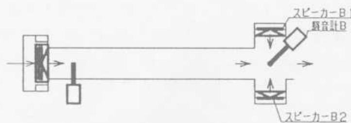
(D) 消音スピーカ2個、エラーマイクは消音スピーカ前面の位置に設置、出口パイプ長さ110mm
