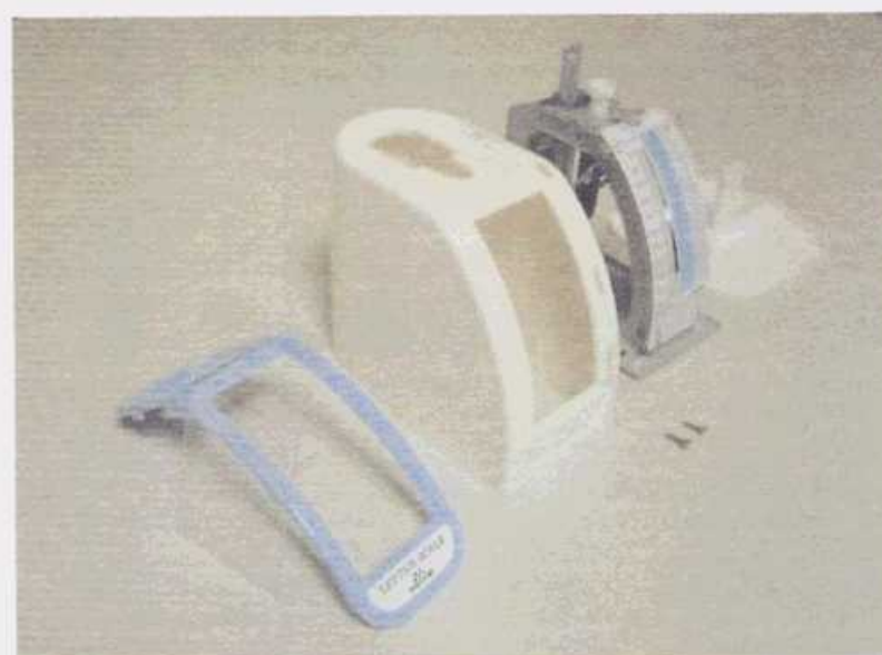
図1 卓上量りの分解過程イメージ
