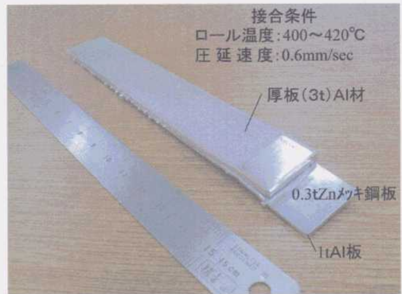
写真4 厚板(厚さ3mm) Al材の接合例
