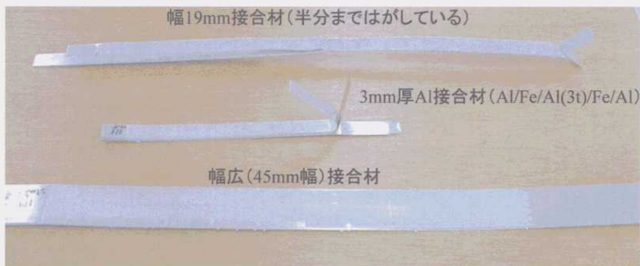
写真2 幅広材(45mm幅、下)、厚板(板厚3mm、中央)材の接合例
