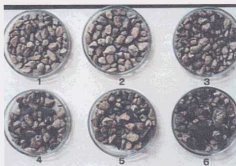
写真 1 塩酸処理した再生粗骨材
