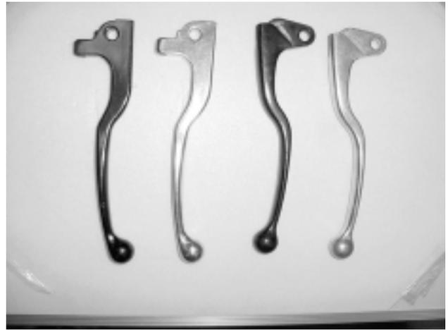
図10 DLC 成膜前（白）、成膜後（黒）のバイクのブレーキレバー
