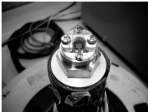
図13 パッケージングされた振動センサ
