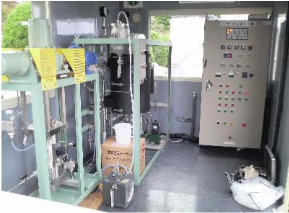
写真1 設置した超臨界水ガス化装置
