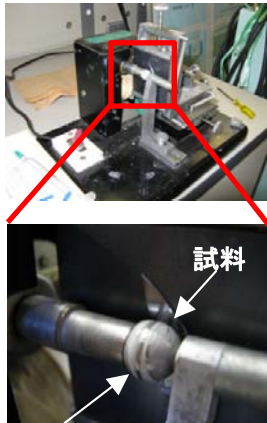
(a) スフィカトル装置 (b) スフィカトル法の原理
