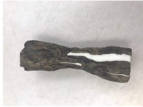
亀裂部に樹脂を補填した状況
