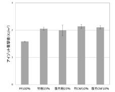
各試験体の衝撃試験結果
