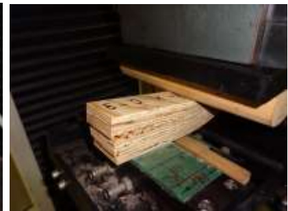
写真6 LVL せん断試験
