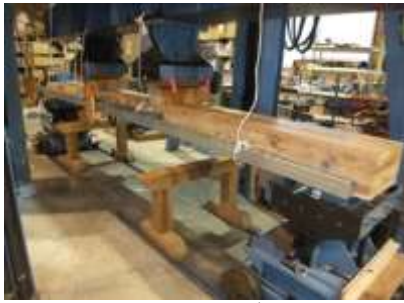
写真1 CLT 曲げ試験
