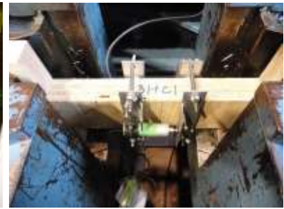
写真3 LVL 縦引張試験
