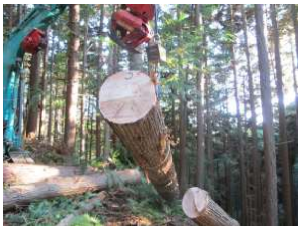
写真4 丸太の重量等計測
