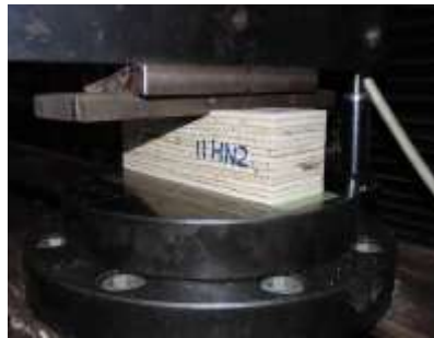
写真5 LVL めり込み試験
