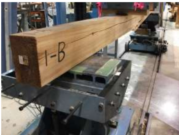
写真5 平角材の曲げ強度試験
