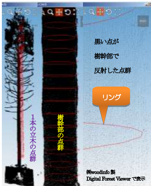
図1 点群データから作成する内接円 (リング)
