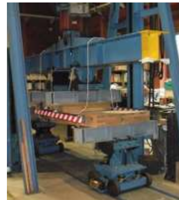
図3 直交集成板(CLT)試験
