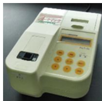
開発したビタミンA測定装置 「Aクイック」(仮称)
