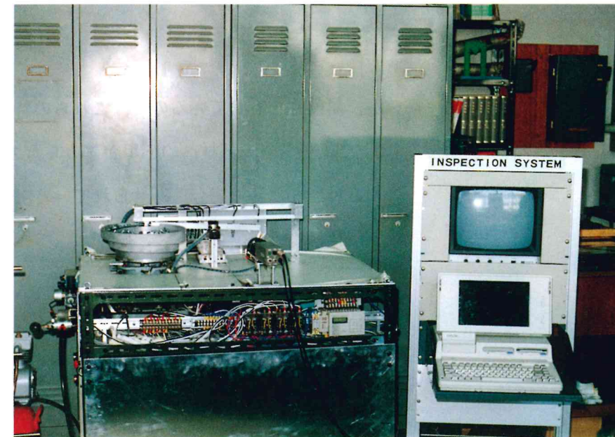
写真2：自動車用ボルト検査装置
