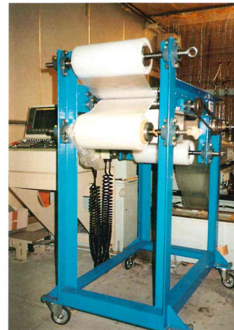
写真1：試作したプリプレグマシン
