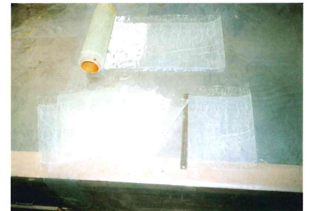
写真2：試作したプリプレグとその裁断の様子
