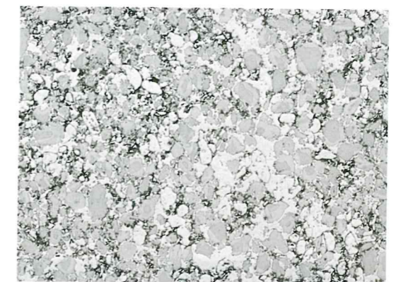
チタン-アルミニウム金属間化合物粒子分散複合材料の組織 良好な複合材料組織を示している。灰色部分がチタン-アルミニウムの金属間化合物である。
