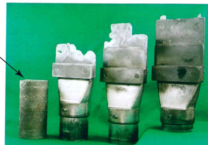
マグネシウム合金複合材料の半熔融状態での成形性
