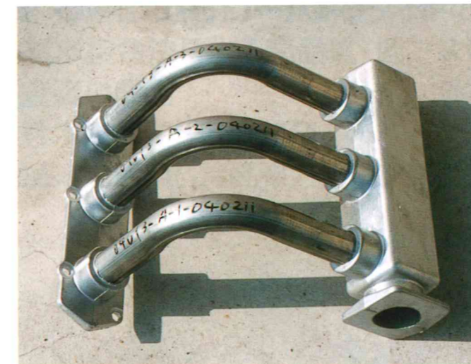
超音波鋳ぐるみ接合技術により作製した チューブラータイプのインタークマニホールド試作品
