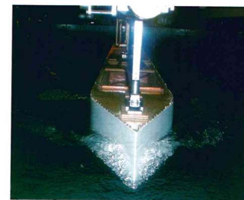
模型船と回流水槽を使用して試験
