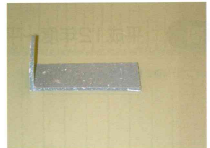
圧縮成形品: 外階段のステップの一部
