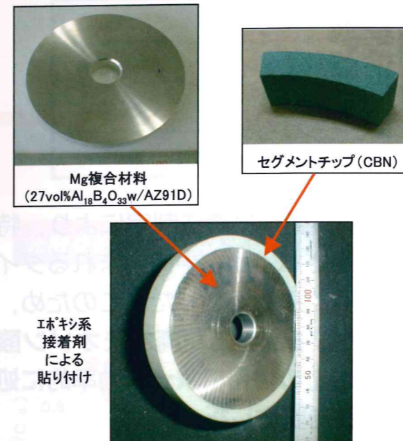
マグネシウム合金複合材料合金を用いた超高速研削ホイール (φ100×10t×15H)
