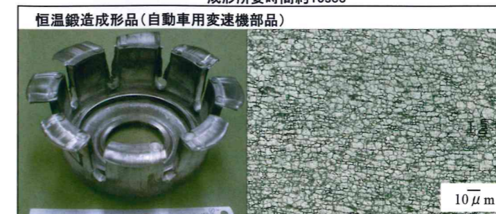
鑄造用マグネシウム合金による恒温鍛造試作品と光学顕微鏡組織
