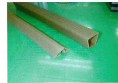
押出成形品: (左) 目地止め材, (右) スノコの一部
