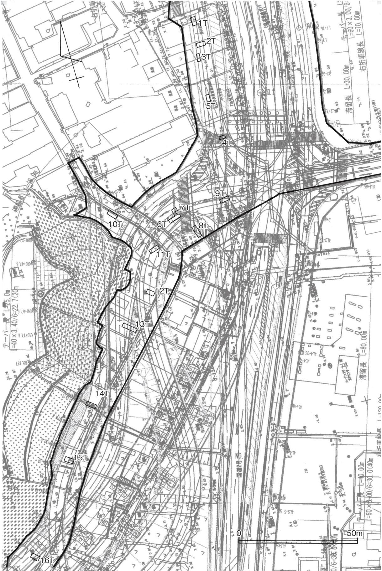
第4図 一般国道2号岩国・大竹道路建設計画地内試掘坑位置図 (1:1,000)
